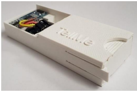
Abbildung 3: durch 3D-Drucker hergestelltes Gehäuse
