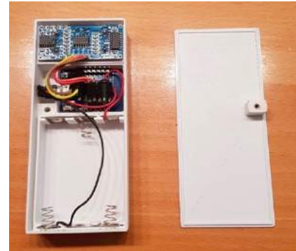
Abbildung 7: durch 3D-Drucker erstelltes Gehäuse
